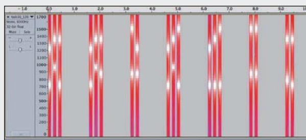
По оси ординат — частота в герцах. Одна вертикальная полоска на спектрограмме — одно нажатие клавиши. Каждая вертикальная полоска имеет два засвета: нижний задает строку в кодовой таблице, верхний — столбец. Считав коды по засветам, получаем
