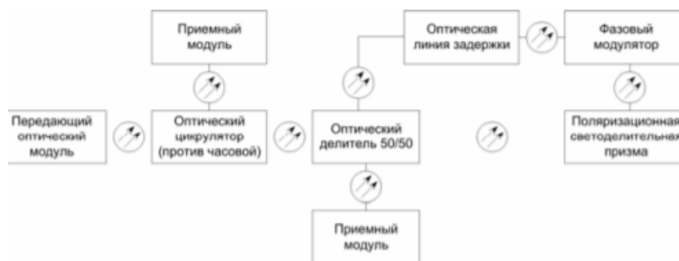
Рис. 3. Схема оптической части устройства Алиса
