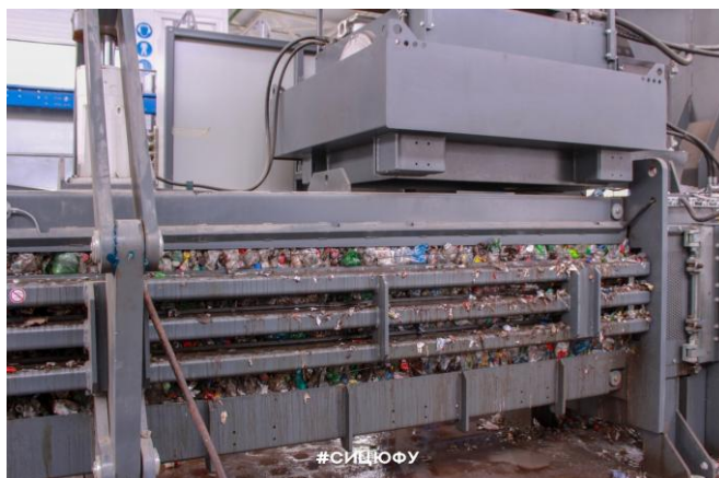
Рис. 1. Предобработка пластика на Неклиновском МЭОК
