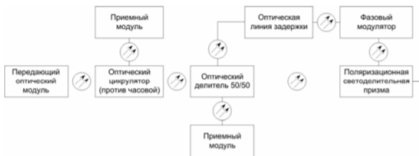
Рис. 2. Схема оптической части устройства Боб
