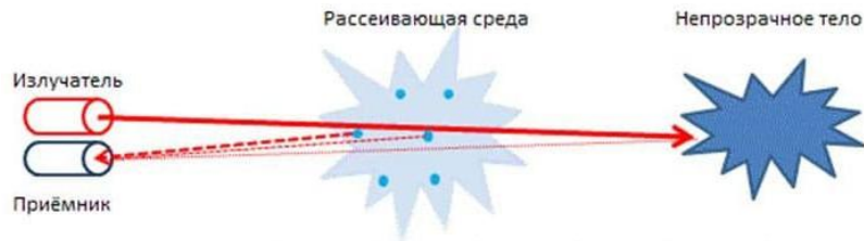
Рис. 3. Принцип работы лидара
