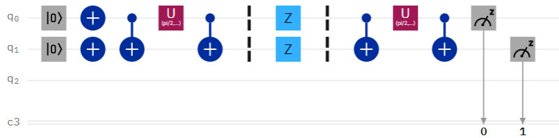
Рис. 6. Квантовая схема игры набранная на симуляторе IBM Quantum Experience, стратегии до запутывания инвертируются
